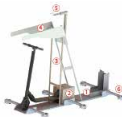
Figura 3. Partes de la plataforma para realizar Cras-test con VMP desarrollada por CESVIMAP
