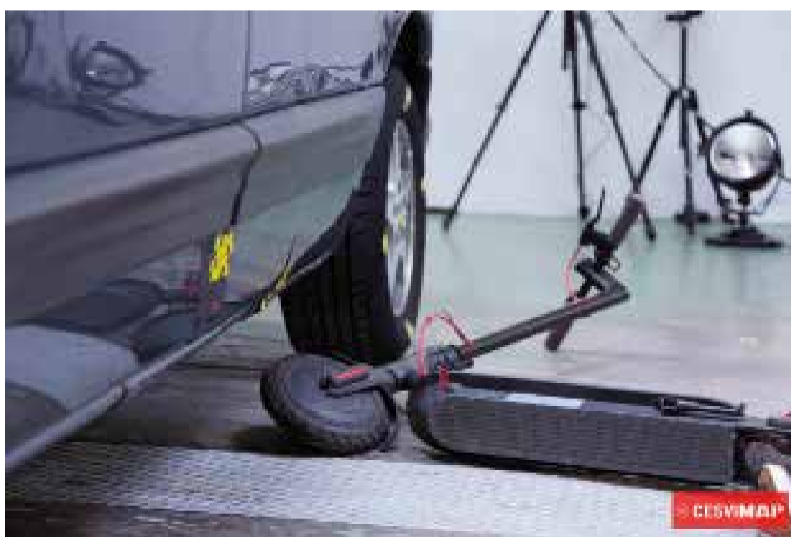
Figura 11. Posición final del VMP después del Crash-test
