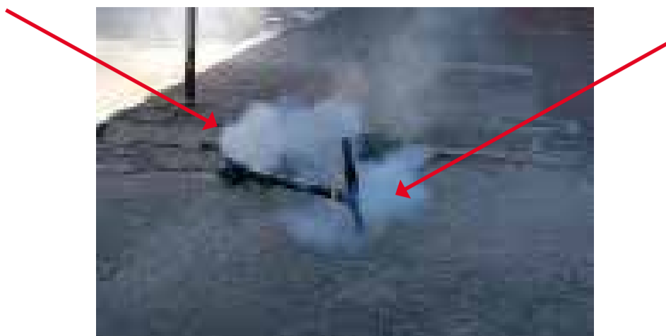
Figura 27. Salida de humo de un patinete eléctrico con batería en la columna de dirección
