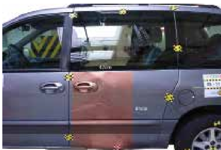
Figura 9. Zona lateral del vehículo afectada durante el Crash-tets
