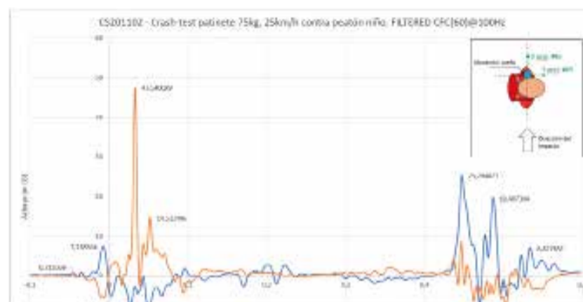
Gráfica 19. Fuerzas (G) producidas durante la colisión entre el atropello a peatón
