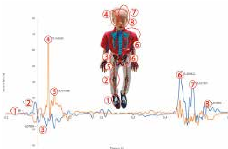
Figura 13. Fuerzas (G) y partes del cuerpo afectadas durante el Crash-test
