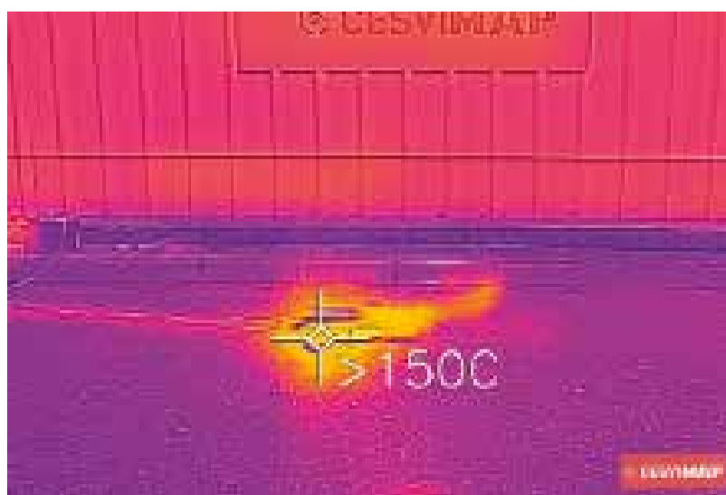
Figura 21. Temperatura máxima alcanzada por una celda
