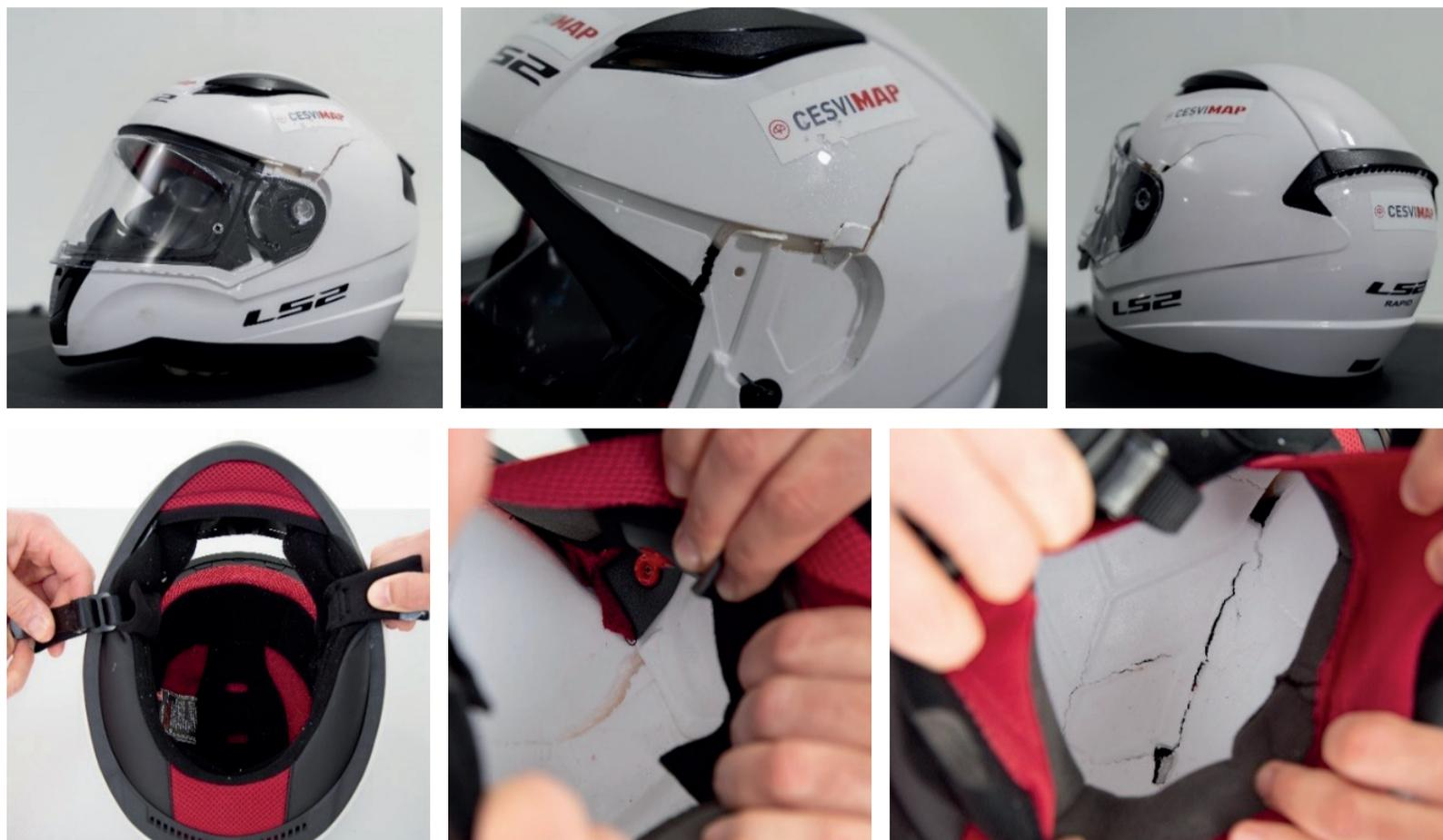
Imagen 29. Ensayo de caída desde altura
