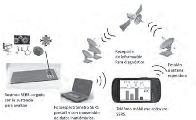
Figura 7. Esquema y funcionalidad del sistema Raman-SERS portátil propuesto..
