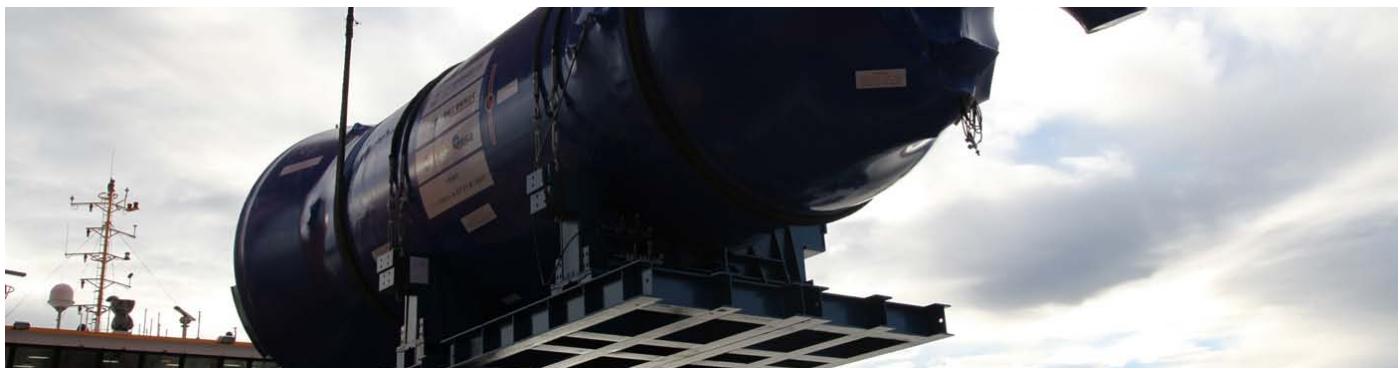
Ensa - Generador de vapor
