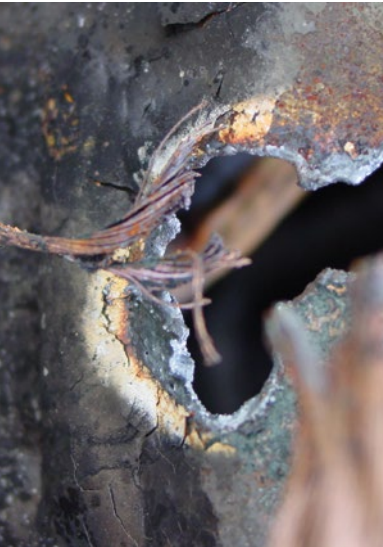
► Cortocircuito en la carrocería
