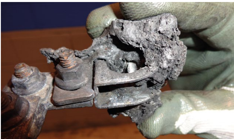
► Borne de conexión a batería afectado
