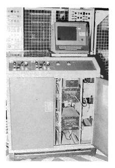
Interior de la consola del robot. Señalado el pulsador para poder mover el robot fuera de su campo de trabajo.
