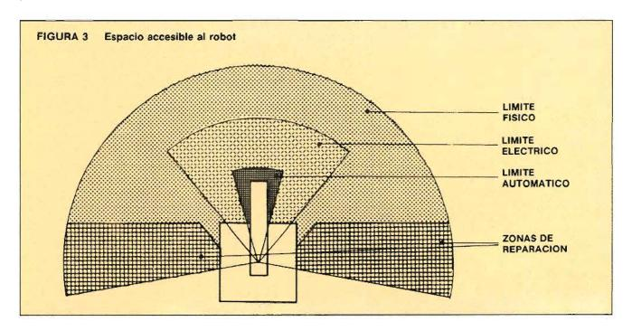
La programación de un robot se realizará con las puertas de las vallas abiertas y en manual, usándose el Teach pendant o elemento programador del robol.
