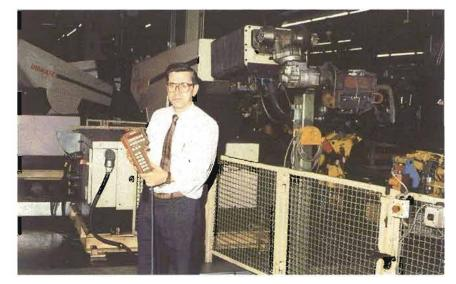
El técnico está situado en la zona de reparación, sólo accesible para un robot. Tiene en sus manos el elemento programador.
