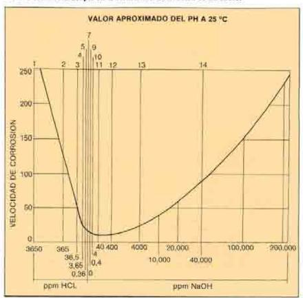
alcalinos disuelven la magnetita, causando así la corrosión del acero.
