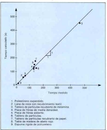
FIGURA 10. Propuesta de clasificación de los materiales de revestimiento ensayados en el Room-Corner Test (ISO 9705). Tomado de Göransson, Ulf. y Sundström, Björn.
