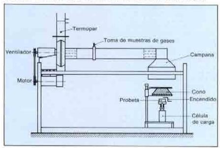
FIGURA 5. Cone Calorimeter. El aparato comercializado en el mercado tiene unas dimensiones de 1.787 mm de largo, 629 mm de ancho y 1.997 mm de alto (2.698 mm con el conducto de salida de gases). Cortesia de Stanton Redcroft (PL Thermal Sciences Ltd.).
