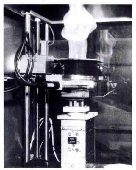
Se anota la duración de las inflamaciones transitorias (flash); cuando se produzca la inflamación sostenida se toma nota del tiempo y se corta la alimentación a la bujia de encendido exterior. Los datos se recogen hasta dos minutos después de finalizar toda inflamación o toda señal de combustión, hasta que la perdida de peso. sea inferior à 150 g/m², o después de sesenta minutos. Hay que observar y registrar los cambios físicos de la muestra, tales como fusión, hinchamiento o agrietado.
