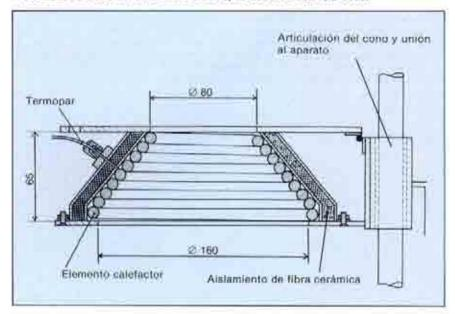
FIGURA 7. El Cone Calorimeter en funcionamiento. Cortesia de Stanton Redcroft (PL Thermal Sciences Ltd.).
