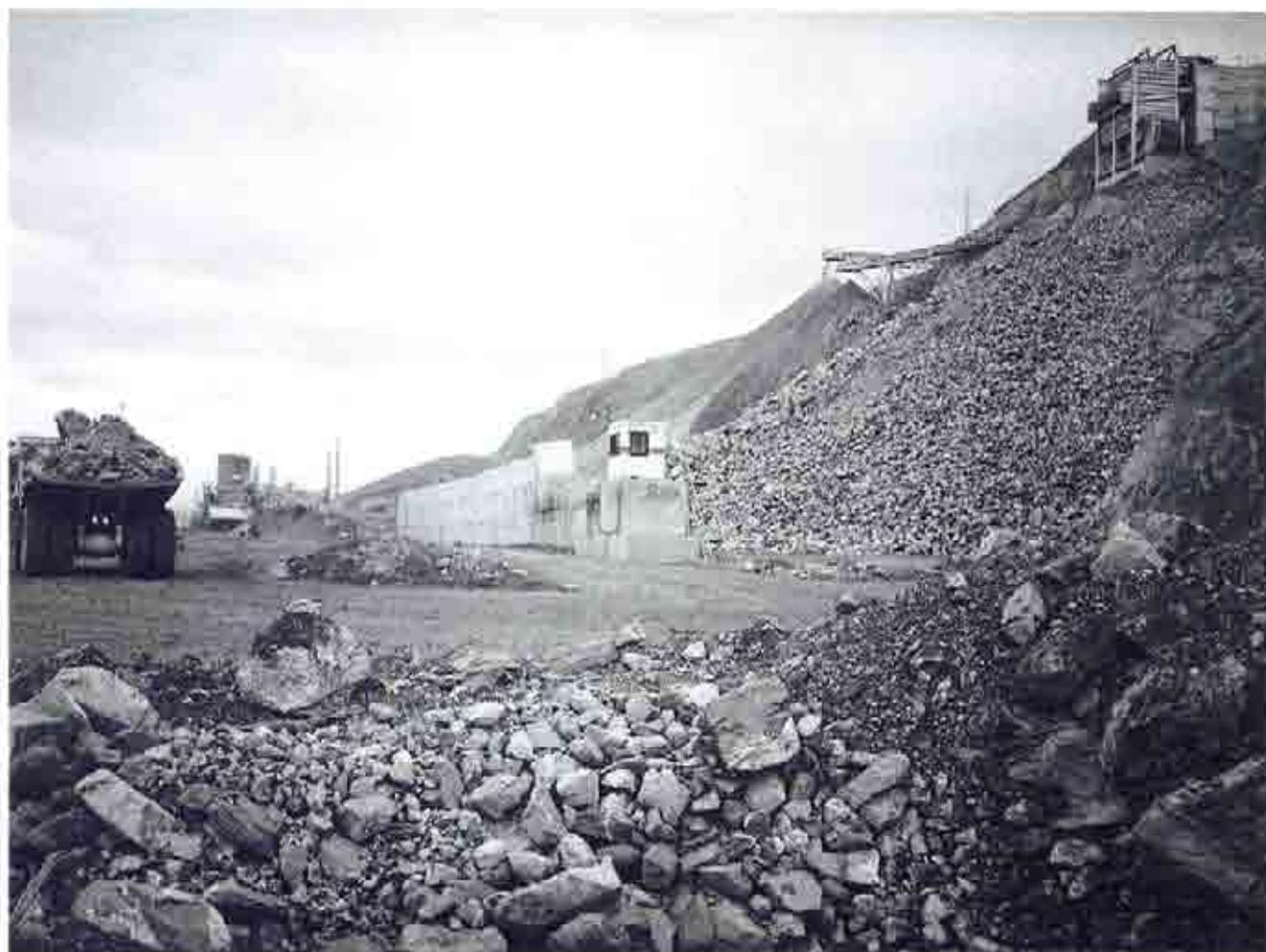
Foto 6 Estación de primario, protección a base de cajones prefabricados.
