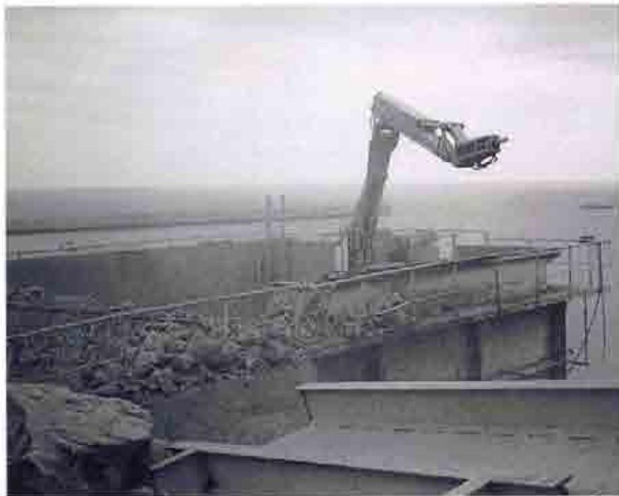
Foto 7. Martillo neumático en tolva de estación de primario.
