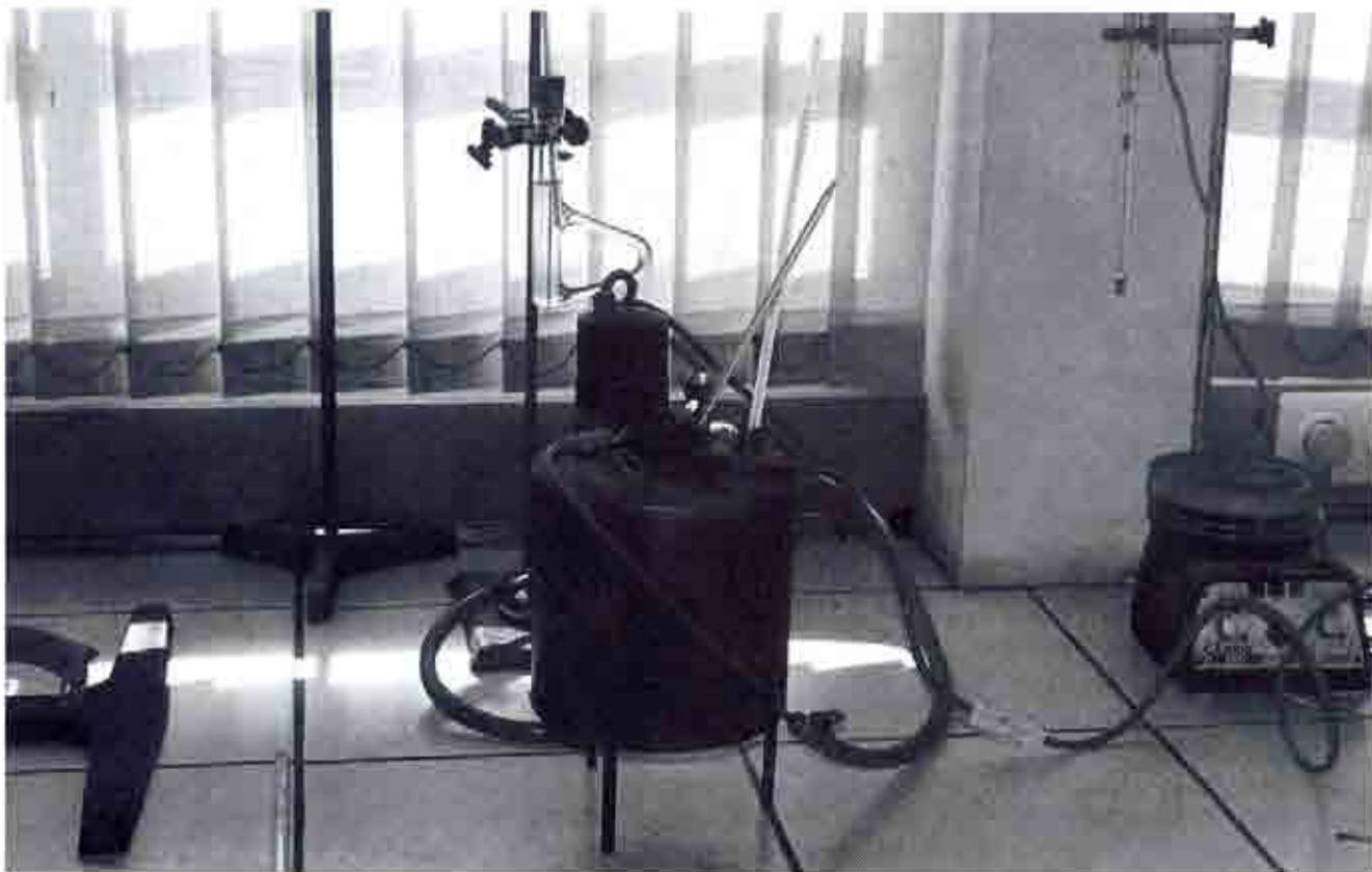
*Aparato de ensayo para la determinación de la temperatura de inflamación.*
