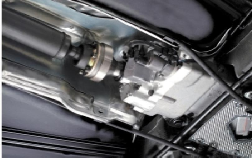
implementación de la tracción al eje trasero supone una modificación del sistema de suspensión. Lo habitual es encontrarse con un sistema de suspensión trasera constituida por un eje semirrigido. La necesidad de introducir las transmisiones en las ruedas traseras implica un cambio importante en el diseño de la suspensión, siendo necesario adoptar esquemas de suspensión de tipo totalmente independiente, más sofisticados, de mejor comportamiento dinámico y de mucho mejor guiado para las ruedas.
