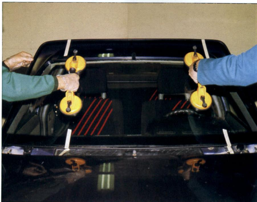
**E**l desmontaje de una luna pegada implica, necesariamente, el corte del cordón de adhesivo que la mantiene unida a la carrocería.
