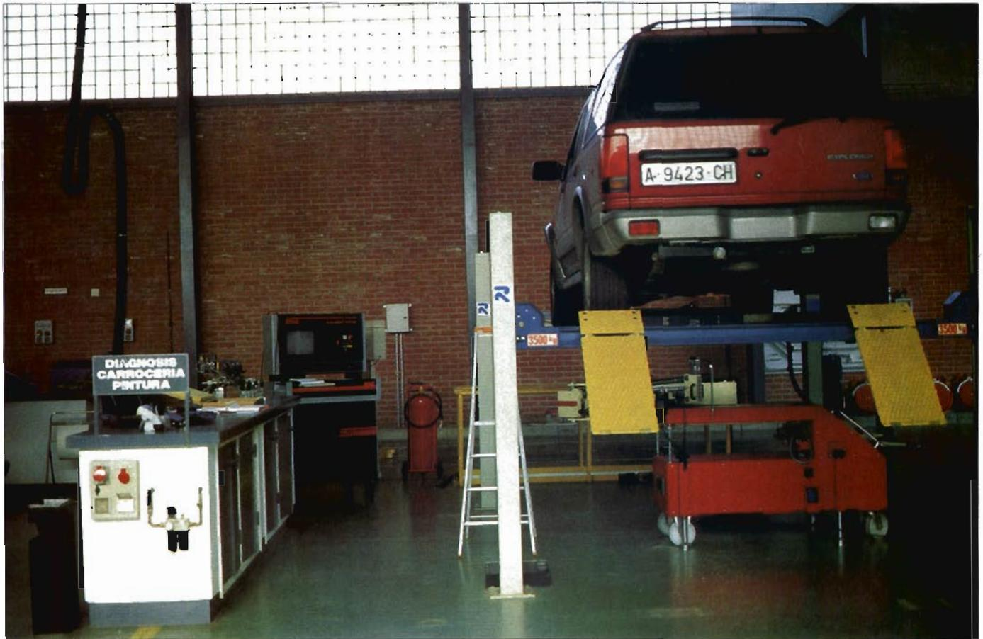
El CDV dispone de una línea de diagnosis específica para la verificación de las cotas de carrocería y estado de la pintura.
