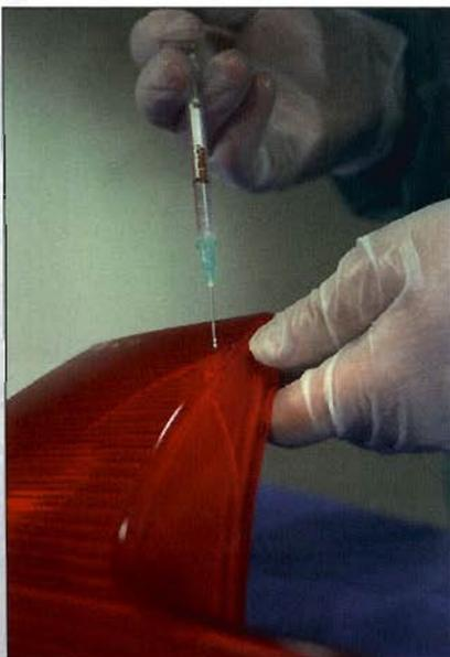
Reparación de una grieta mediante aplicación de cloroformo.
