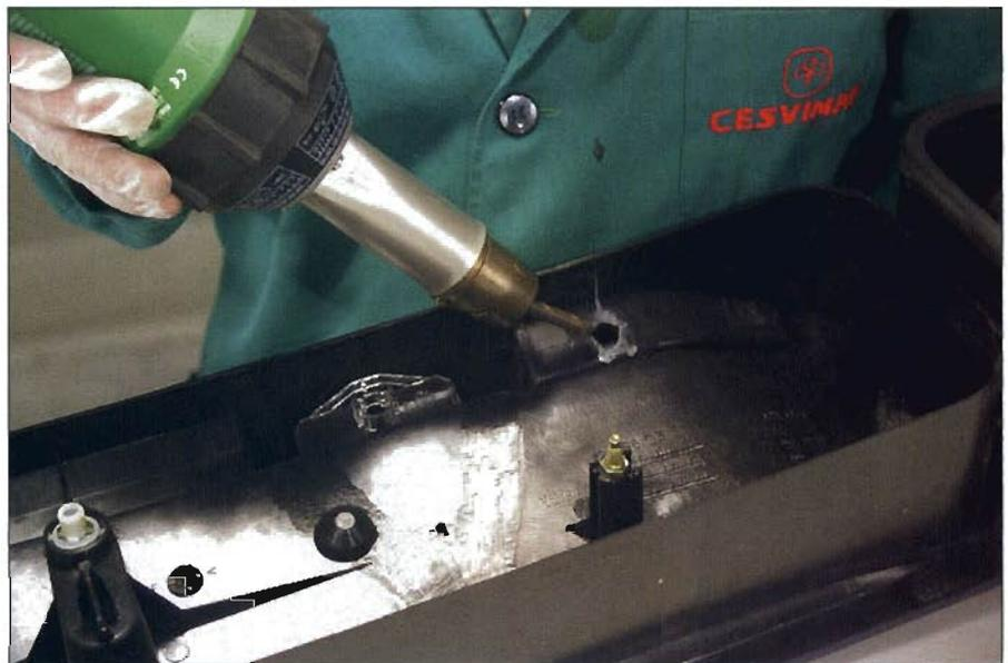
Conformación de la zona mediante calor.
