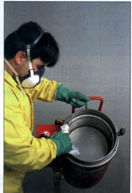
Limpeza del tanque de disolvente
