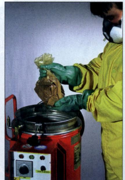
Extracción de lodos de destilación.
