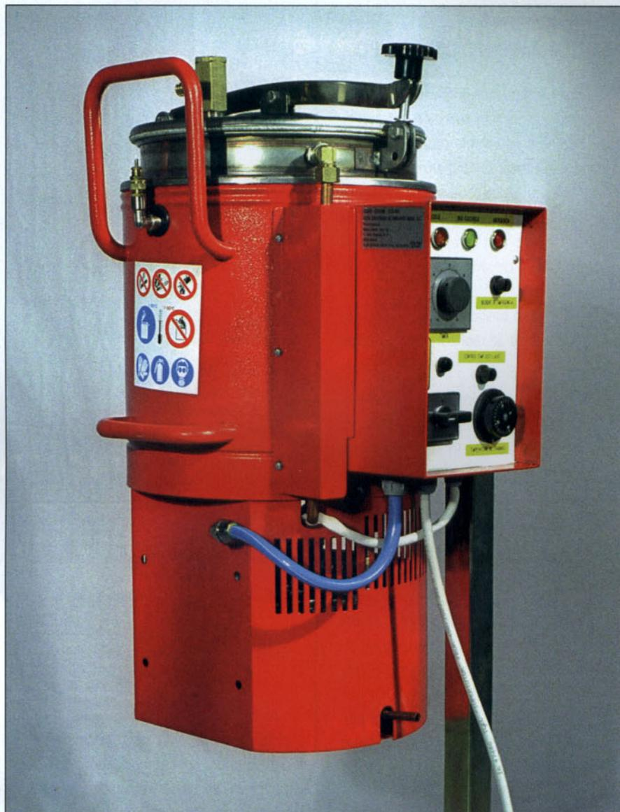
**E**l reciclado del disolvente consiste en su destilación en una cuba cerrada calentándolo hasta evaporar. Dicho vapor se recoge y se hace condensar por enfriamiento, mientras que sus impurezas quedan en la cuba. Esta técnica es posible gracias a que cada disolvente tiene una temperatura de cambio de fase líquido-vapor característica y a que ésta se mantiene constante durante el tiempo que tarde en pasar todo este líquido al estado de vapor.
