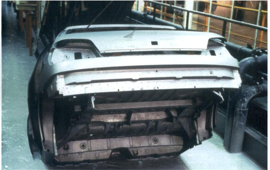
Los revestimientos de bajos se aplican en las zonas inferiores, debido a su exposición directa a las condiciones atmosféricas y a la proyección de materiales durante la conducción
