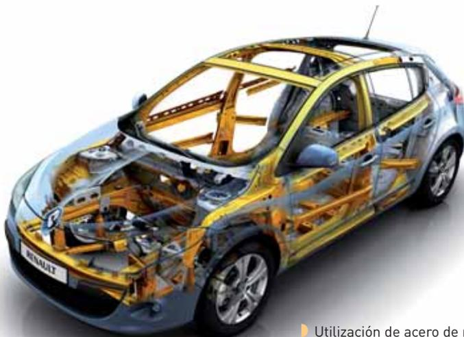
Utilización de acero de muy alto límite elástico en la carrocería
