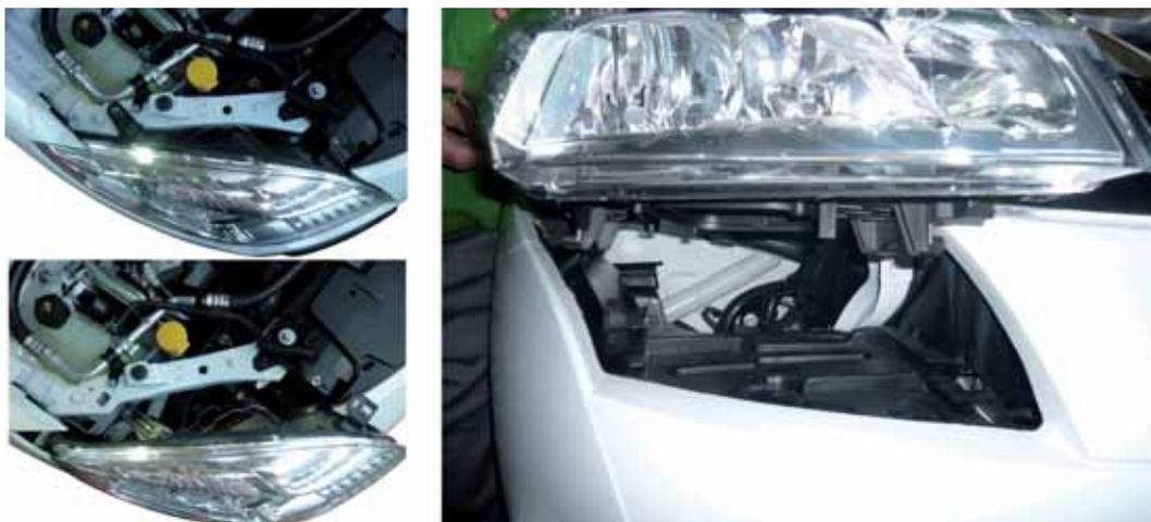
► Guías del faro y colocación de lámparas
