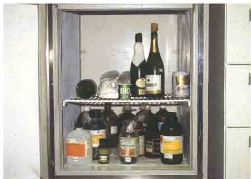
En ocasiones podemos encontrarnos situaciones como éstas. No se deben almacenar alimentos en frigoríficos destinados a la conservación de productos químicos.
