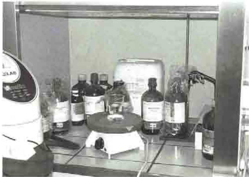
En la cabina de extracción localizada no es recomendable almacenar productos químicos.
