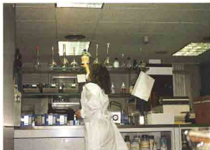
Almacenar productos químicos peligrosos en estanterías elevadas es un factor más de riesgo.
