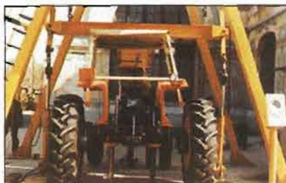
Fig. 12.— Prueba de aplastamiento frontal durante el ensayo de un bastidor con protección.
