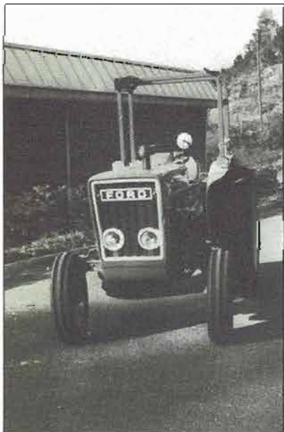
Fig. 3.—Arco de cuatro postes para tractor estrecho.
