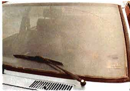
Cristales laminados. En caso de rotura los fragmentos de cristal permanecen unidos en una sola pieza.
