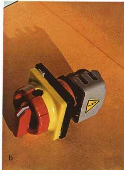
Interruptores de paro de urgencia; ya no se exige que el fondo amarillo sea circular.
