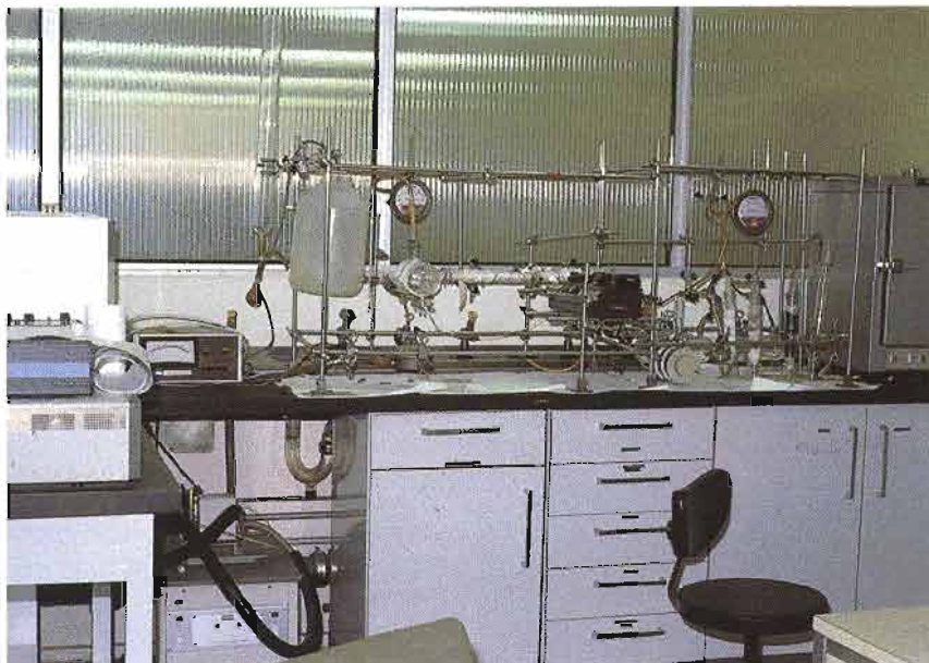
Instalación de una atmósfera dinámica por el método de inyección.
