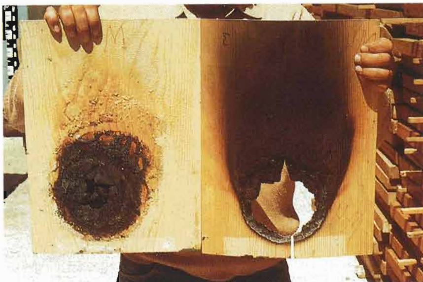
Diferencia entre madera ignifugada (izq.) y sin ignifugar (dcha.) tras ser sometidas a un ensayo de fuego.
