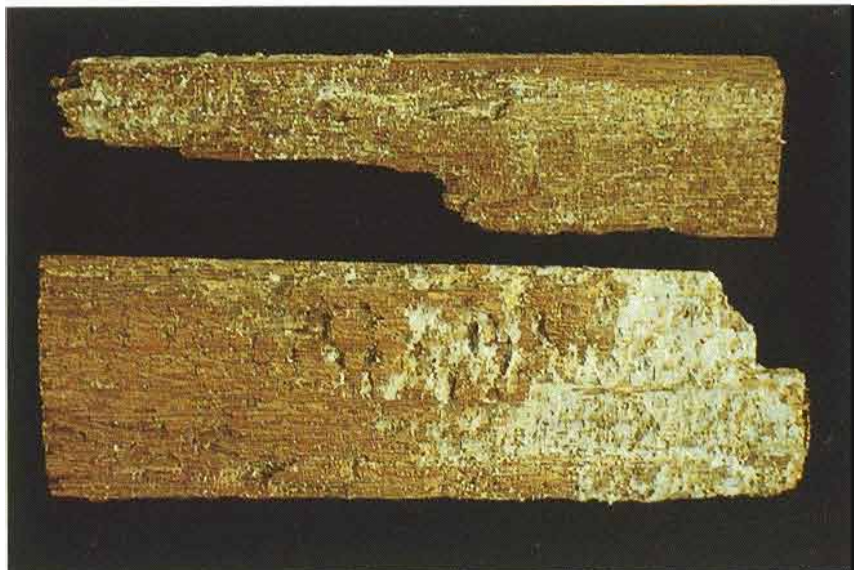
Madera afectada de pudrición blanca, mostrando un micelio superficial sobre su superficie.
