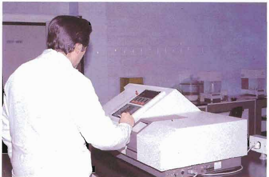
Análisis de la sílice libre que contiene los polvos por espectrofotometría de infrarrojos.
