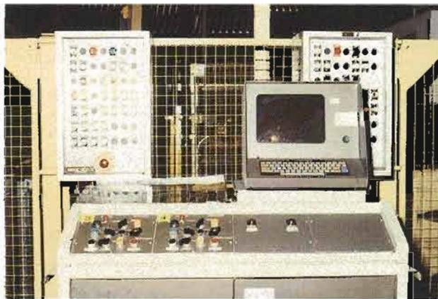
Consola de dos robots. Los conmutadores de llave para intercondensar los Robots Industriales están a la derecha.
