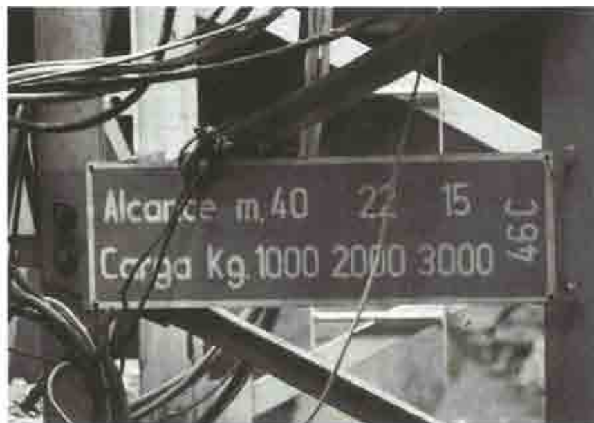
En la placa de fabricación se indicarán las cargas y distancias de trabajo.
