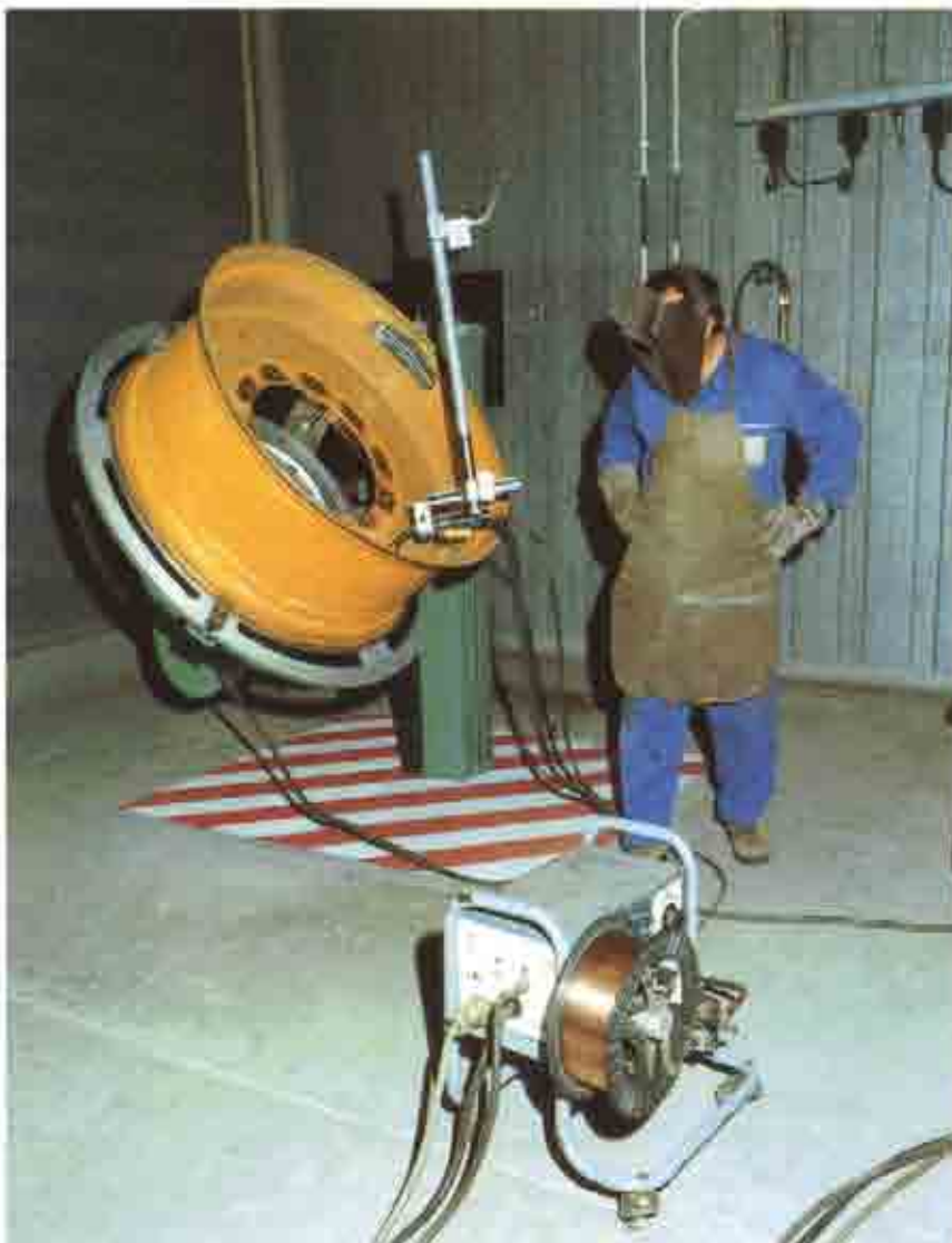
Soporte para soldadura automática en llantas - (después).
