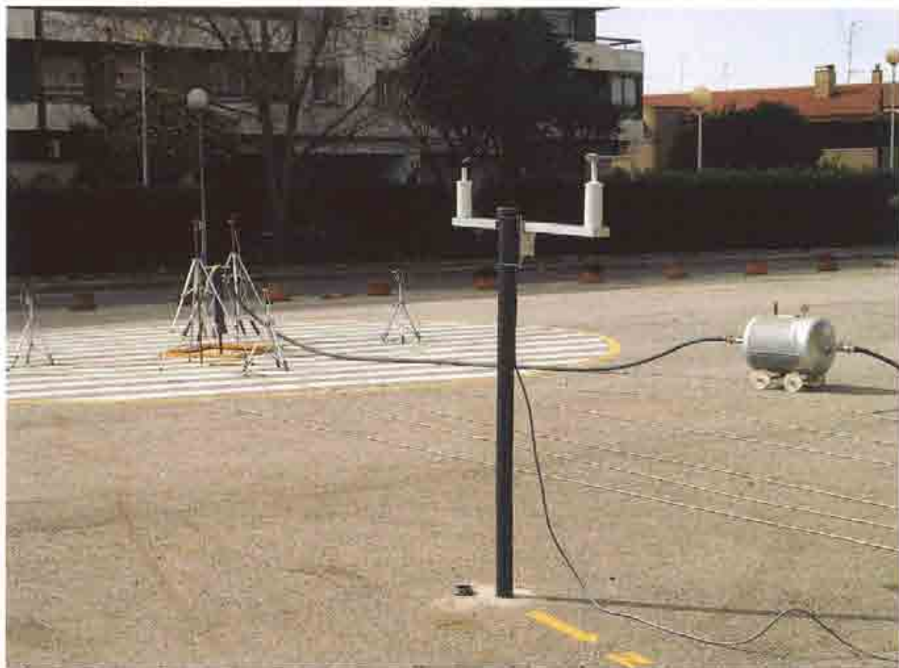
Cuando la velocidad máxima del viento, sea superior a 8 m/s, los micrófonos llevarán protectores.
