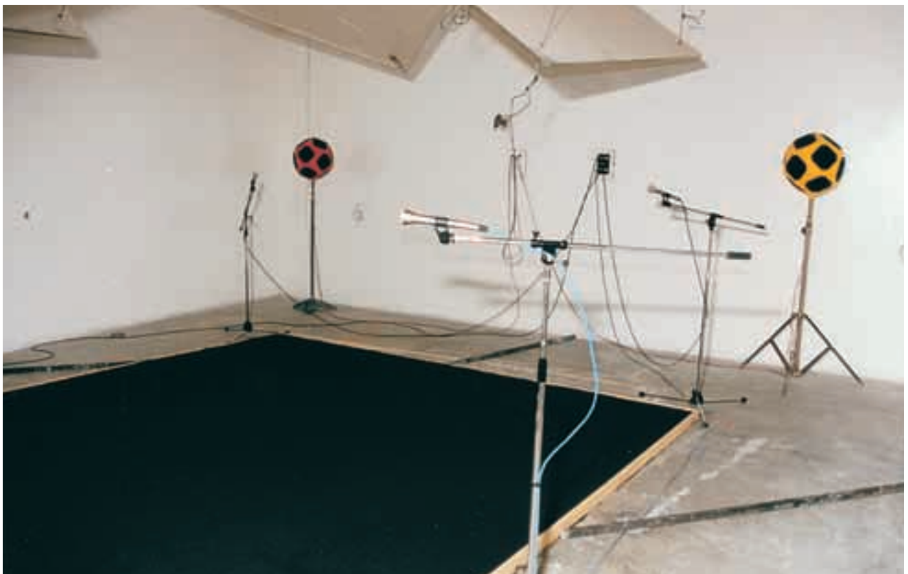
FIGURA 10. Detalle del montaje del ensayo de coeficiente de absorción en la cámara reverberante del Instituto de Acústica (CSIC).
