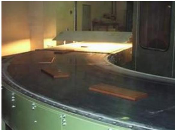
Una vez seca la pieza, se le aplica una primera capa de barniz o pintura (fondo); se deja secar de nuevo y se vuelve a lijar y pintar (acabado). Las dos últimas operaciones pueden repetirse a criterio de la empresa.
