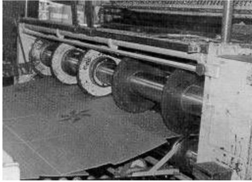
**Fig. 8: Salida de láminas de cartón del cuerpo rendijador hacia el mecanismo de transporte-apilamiento. Órganos de corte accesibles**
