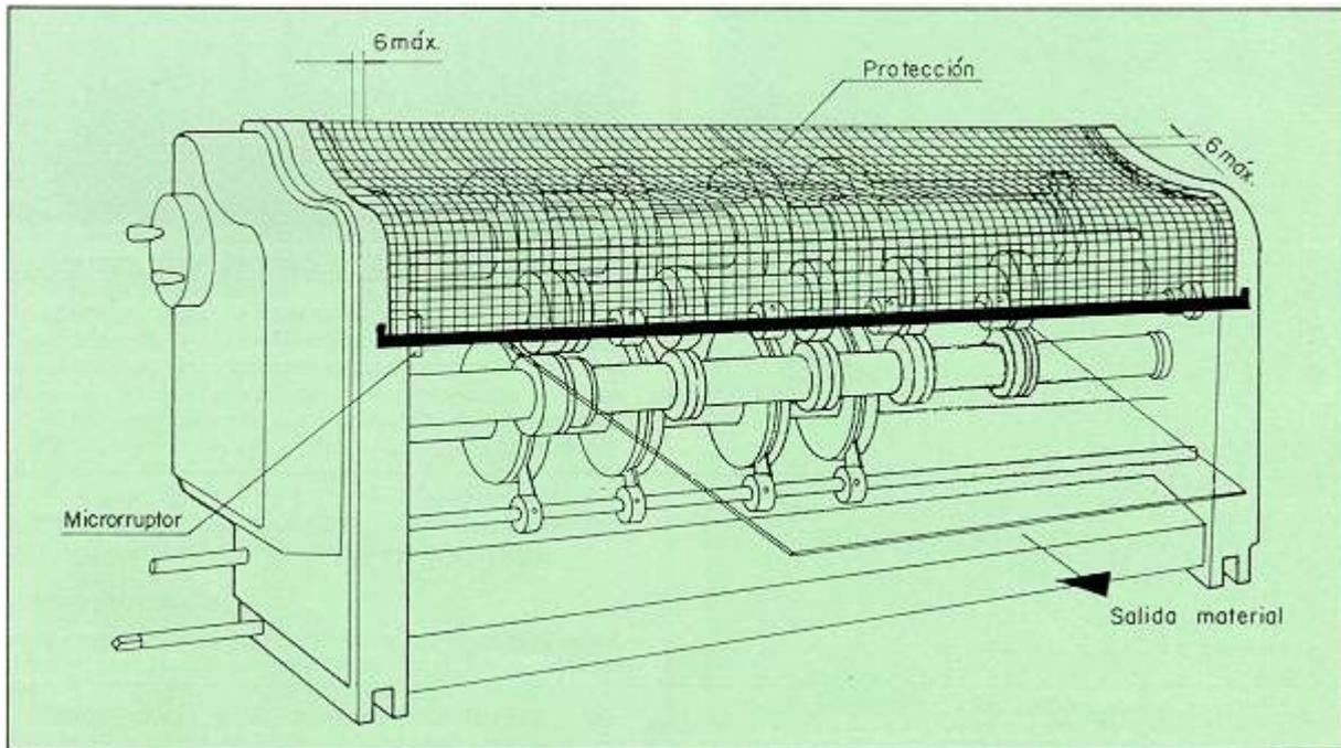
**Fig. 5: Pantalla protectora. Cuerpo Slotter**
