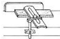
Para operaciones de planeado, el protector puede reglarse en altura mediante el tornillo existente en la abrazadera y en profundidad hasta establecer contacto con la guía, de modo que cubra toda la longitud del árbol portacuchillas, pasando la pieza por debajo de la placa. Asimismo, puede utilizarse como protector tan sólo del fragmento de árbol portacuchillas no ocupado por la pieza.
