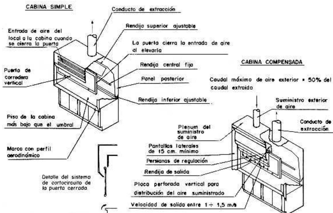
El caudal de aire que debe extraerse de una cabina de este tipo varía, en función de los materiales que se manipulen en ella, desde 1300 m<sup>3</sup> por cada m<sup>2</sup> de abertura para productos corrosivos o moderadamente tóxicos, hasta 2300 m<sup>3</sup>/h. por m<sup>2</sup> de abertura para productos muy tóxicos (TLV inferior a 0,1 mg/m<sup>3</sup> ó 10 ppm).
