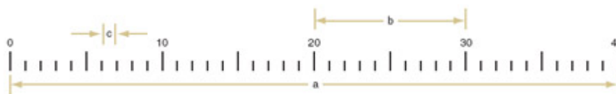
Figura 9 Ejemplo de escala en la que el rango (a) es 40, el intervalo numérico (b) es 10 mientras que el intervalo de graduación (c) es 1
