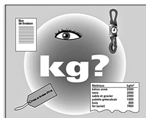
Figura 11. Respetar la carga máxima del cable según el fabricante
