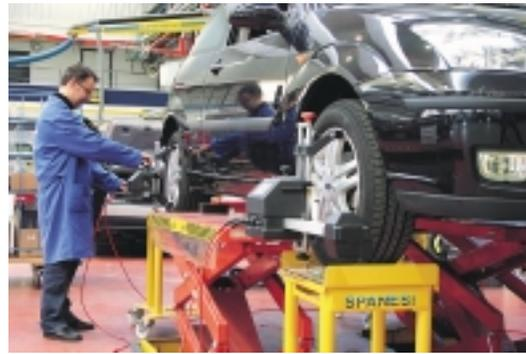
Una de las características de este equipo es la posibilidad de medir con ruedas alzadas, lo que permite regular el vehículo con las cuatro ruedas elevadas del terreno. Esto evita que el peso del vehículo fuerce los dispositivos de regulación, impidiendo su uso.
