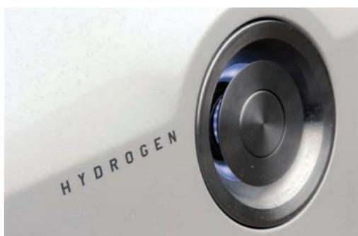
► Boca de carga de hidrógeno a presión
