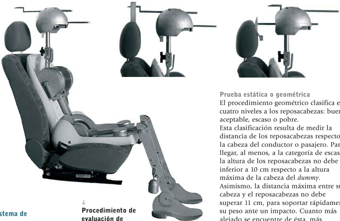
El sistema de clasificación de los asientos y reposacabezas de los automóviles abarca dos pruebas: estática y dinámica
