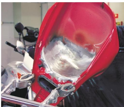
Recuperadas las formas originales del depósito, será necesario cerrar la ventana. El trozo cortado se fijará al depósito mediante puntos de soldadura MIG, ajustándolo al hueco. Una vez colocado, se soldará el corte por medio de un cordón de soldadura MIG de hilo continuo.
