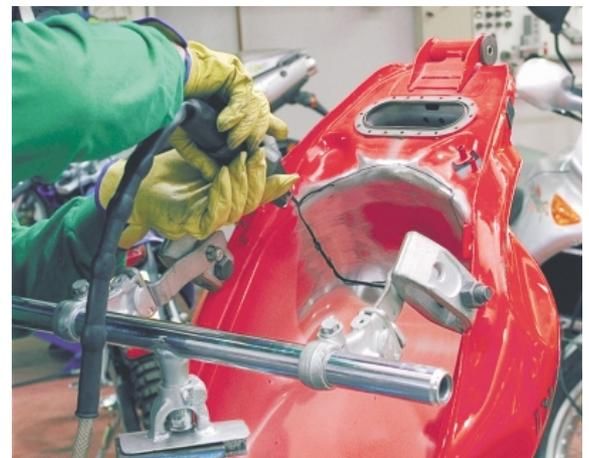
Para realizar la sección de una manera homogénea, el reparador puede ayudarse de un rotulador para trazar la línea de corte. Esta línea servirá de guía para realizar la apertura.
