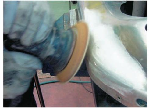
Después de recuperar la forma del cubrecárter, es preciso darle el aspecto final. Por lo general, este tipo de piezas no lleva recubrimiento de pintura, que podría igualarse, sino un tratamiento denominado anodizado, proceso que transforma la superficie del aluminio en óxido de aluminio, proporcionando una excelente protección y alta resistencia, a la vez que un acabado estético.
