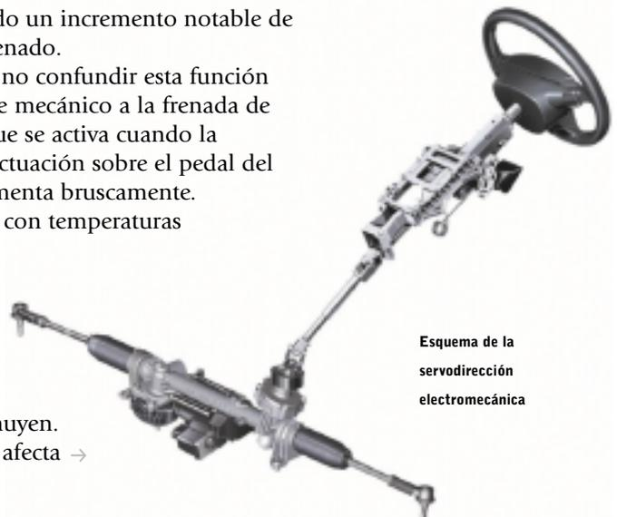
Esquema de la servodirección electromecánica
