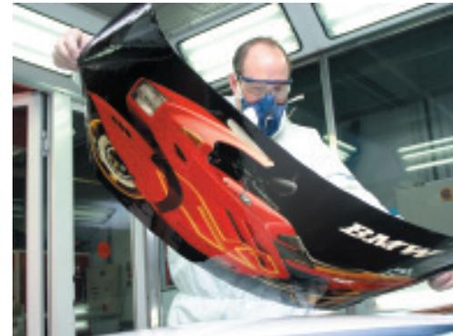
Colocación de un póster para transferir el dibujo a la pieza
