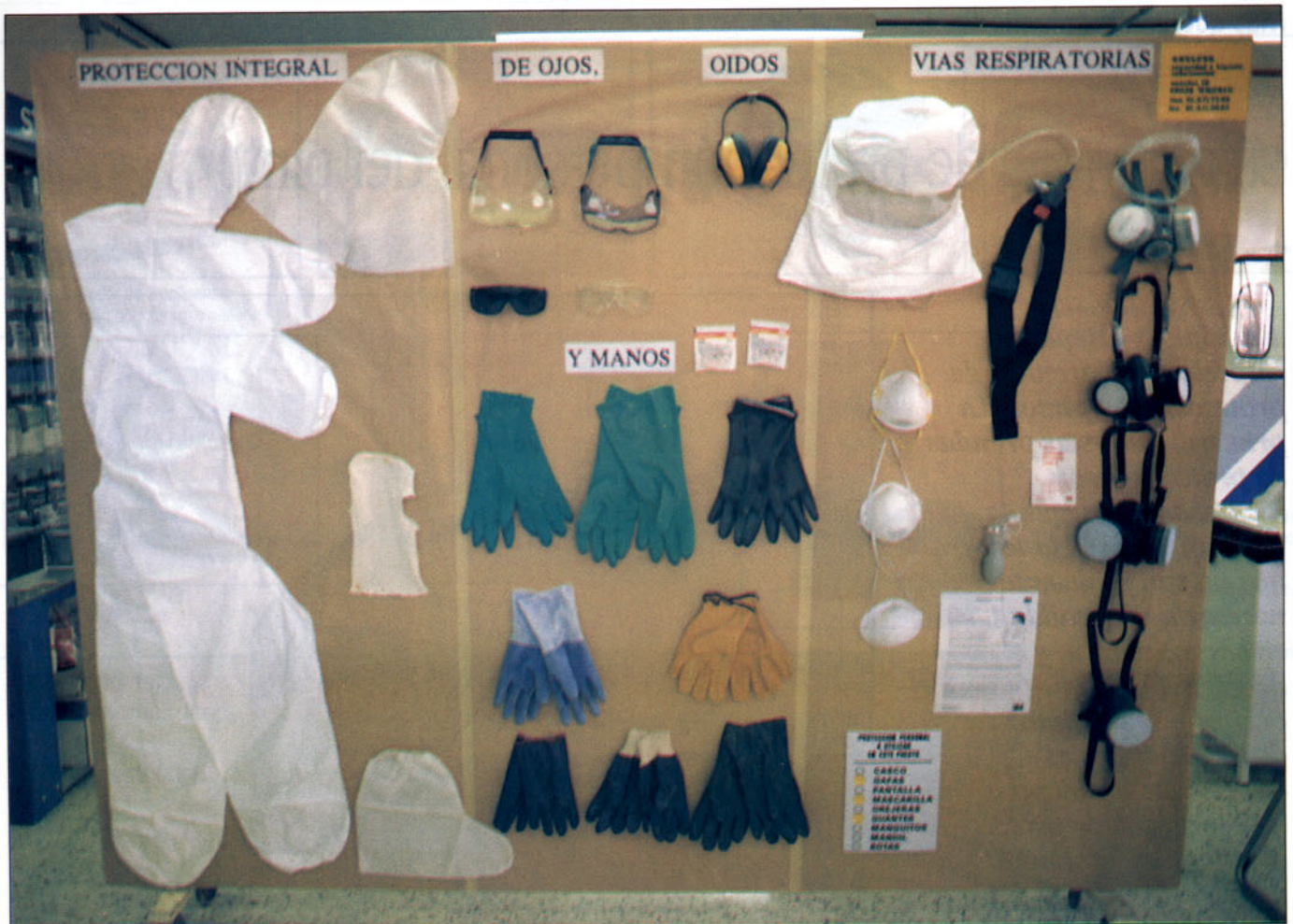
Principales prendas de protección utilizadas en trabajos de pintura.
