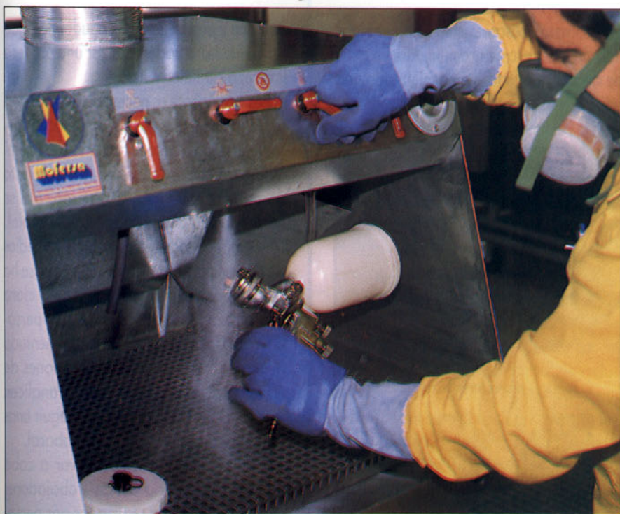
Protección de manos y vías respiratorias en el lavado de equipos.
