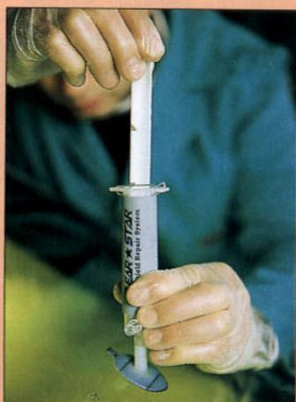
Foto 9. Bloqueo del émbolo en posición de depresión.
