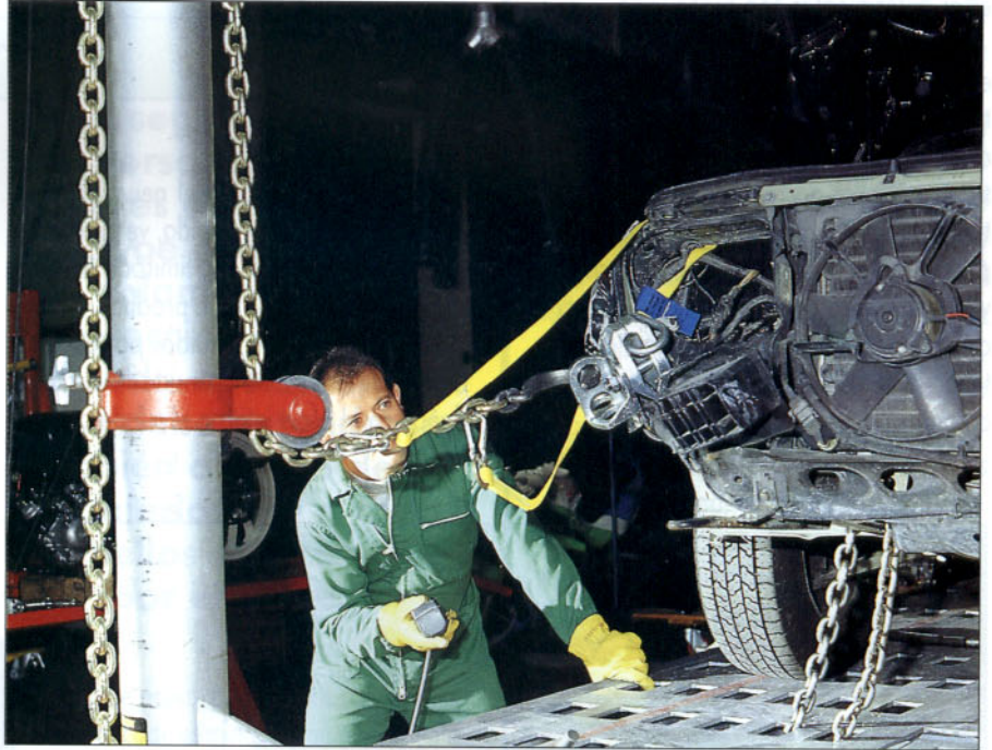
Estiraje de una carrocería con eslinga de seguridad.
