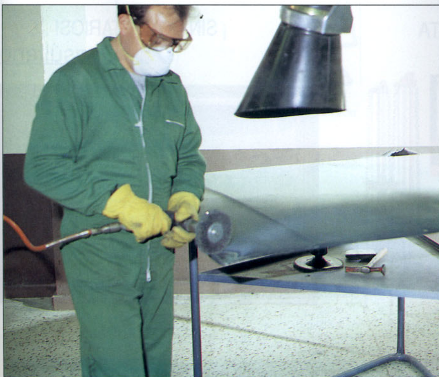
Lijado de pintura con mascarilla y extracción directa.
