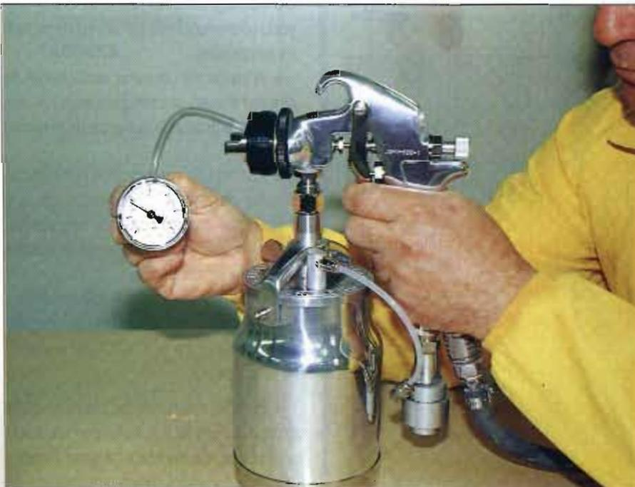
Medición de presiones en el cabezal.
