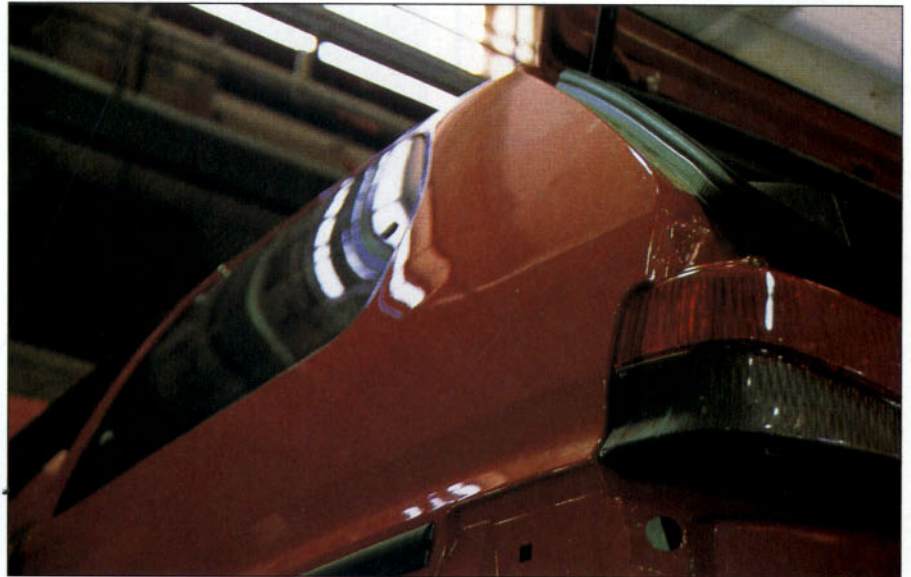
"Costillas" en la aleta trasera izquierda
