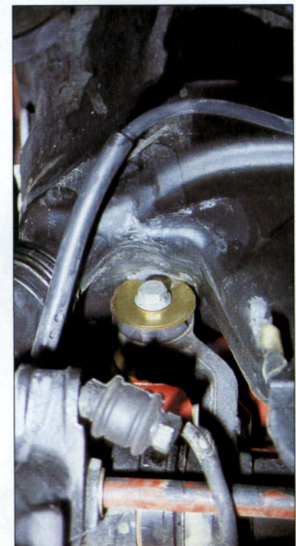
Detalle del depósito de combustible y fijación de amortiguador
