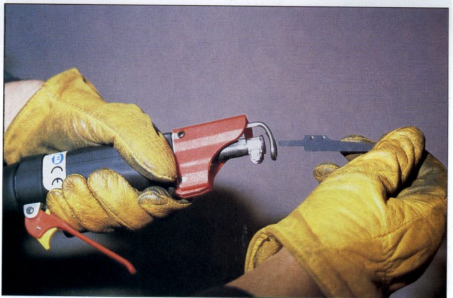
El cambio de la hoja de sierra se realiza fácilmente actuando sobre el tornillo de la abrazadera.
