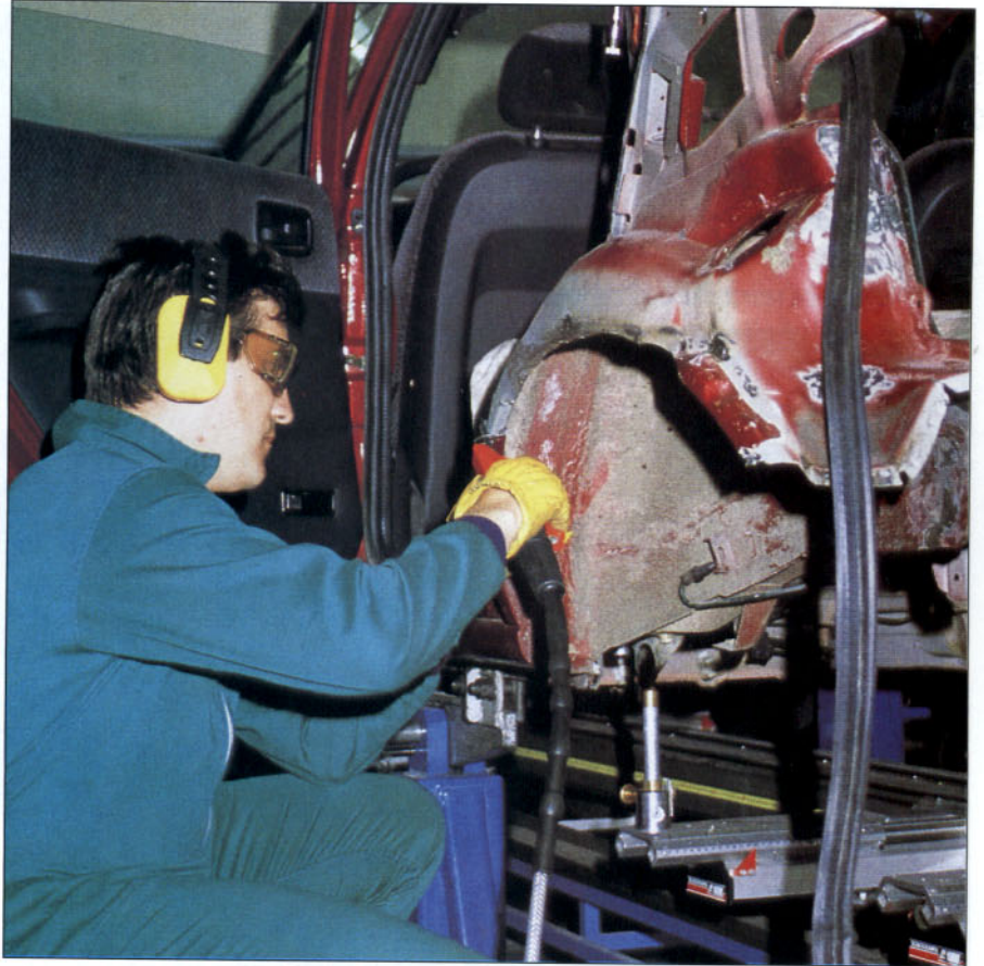
Empleo en una sustitución por sección parcial.
