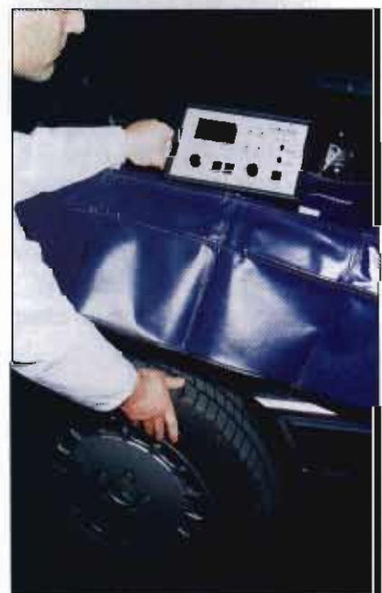
Comprobación del funcionamiento de las electroválvulas.
