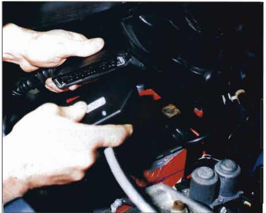
El primer paso será sustituir el calculador de ABS.
