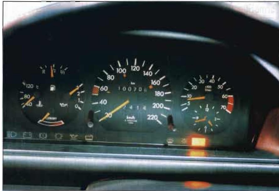
La avería en el sistema ABS se indica mediante un chivato en el cuadro de instrumentos.
