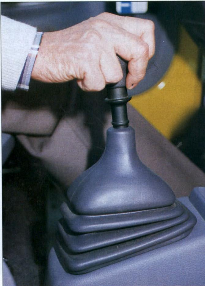
Palanca de cambios en posición "empujado".
